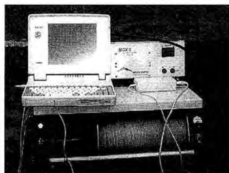
Fig. 8 – Equipamento digital para a realização de diaggrafias: logger, cabo multicondutor, guincho, PC portátil.
