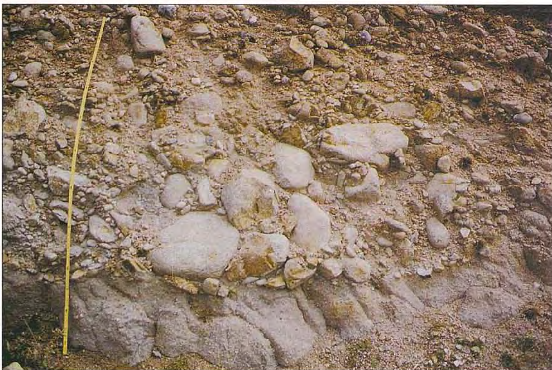
Foto 4 – Depósito de terraço conglomerático, apresentando grandes blocos rolados de granito lexiviado, ravinante sobre as Arcoses de Vilariça. Trata-se do mesmo local apresentado na foto 1. A régua mede 2 m.
